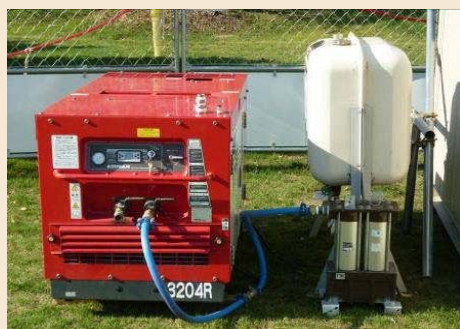
汎用のコンプレッサーを使用して注入が可能です。
