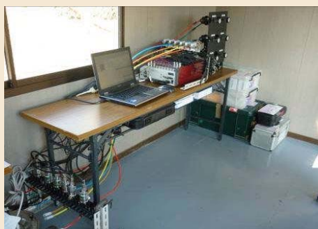
圧力計、流量計にて空気を計測し、減圧弁にて所定条件に制御します。
