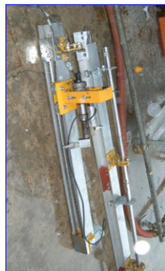
分割・小型化された専用の圧入装置, WJ削孔装置
