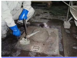
コンクリート試験(スランプ)
